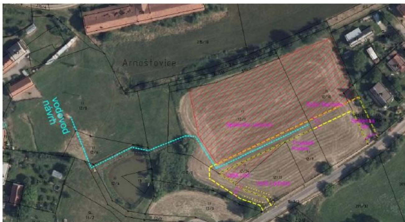
Obrázek 3 - situace návrhu vodovodní sítě (plocha Zm2-1)
